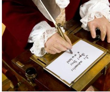
Assis devant un pupitre, l'automate tient une plume d'oie qu'il trempe dans l'encrier, puis il la secoue légèrement avant de commencer de dessiner les lettres sur le papier. L'Ecrivain est capable de tracer un texte de 40 signes au maximum, répartis sur quatre lignes. La principale invention de son mécanisme est le système de programmation par disque, qui lui permet d'écrire des textes suivis sans intervention extérieure. Il peut écrire n'importe quelle phrase, lettre par lettre.
