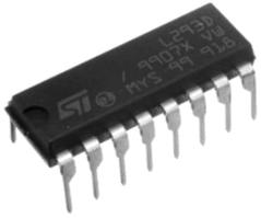
Les éléments précédents permettent de commander un moteur ou une pompe, mais uniquement dans un sens. Pour **tourner dans les 2 sens**, il faut utiliser un **pont en H** comme le **L293D**. Prévu pour commander des moteurs, il **intègre des diodes de roue libre**.
