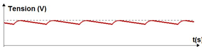
Signal en sortie du pont de diodes avec un condensateur
