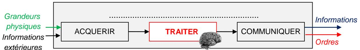
Les informations issues de la fonction « acquérir » doivent être **TRAITÉES** pour que des décisions soient prises. En électronique, il est possible d'utiliser :
